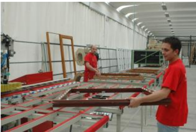
Bild 9 Der Ausstoß der HolzAlu-Elemente wurde mit einer separaten Montagestrecke deutlich gesteigert. Der neue Klipse-Setzautomat mit automatischer Zuführung und Zwangantrieb trägt maßgeblich zur Produktionssteigerung bei.
