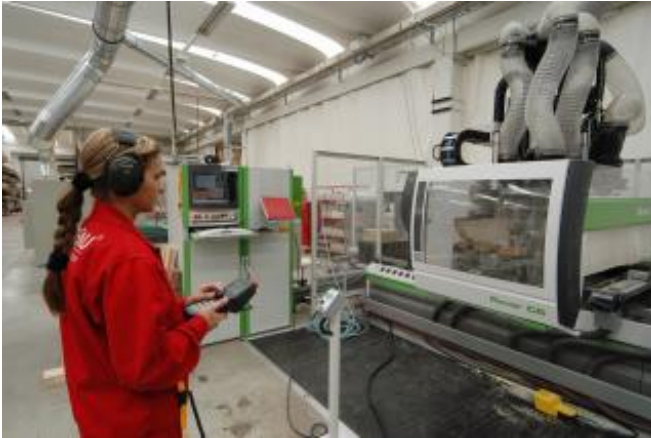
Bild 8 Bogen für Fenster und Haustüren, sowie Ausfachungen jeder Form werden mit dieser Hochleistungs-CNC-Fräse neuester Entwicklung in bester Qualität gefertigt.
