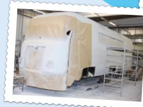
März 2009: Die gesamte Außenverkleidung ist angebracht und wird glattgeschliffen; das Lackieren wird vorbereitet
