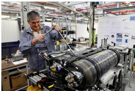
Die aus leichtem Verbundwerkstoff mit Karbonfasern bestehenden Erdgastanks des Zafira Tourer 1.6 Turbo ecoFLEX CNG führten gegenüber dem mit konventionellen Stahltanks ausgerüsteten Vorgänger zu einer Gewichtsreduzierung von 85 Kilo. Außerdem konnten die Ingenieure das Tankvolumen von 21 auf 25 Kilo Erdgas steigern und dadurch die CNG-Reichweite auf über 500 km erhöhen.
