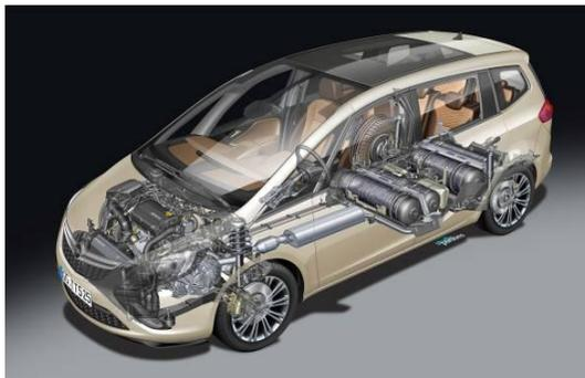
Der jetzt erhältliche Zafira Tourer 1.6 Turbo ecoFLEX mit Erdgasantrieb ist mit hochmodernen Tanks aus Verbundwerkstoff mit Karbonfasern ausgerüstet. Sie ersetzen die Stahlbehälter des Vorgängers und fassen 25 Kilo Erdgas, was zu einer 25-prozentigen Reichweitensteigerung führt.
