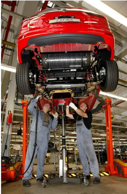
Durch die aus leichtem Verbundwerkstoff mit Karbonfasern bestehenden Erdgastanks des Zafira Tourer 1.6 Turbo ecoFLEX CNG konnten gegenüber dem Vorgänger 85 Kilo Gewicht eingespart und die Reichweite um rund 25 Prozent gesteigert werden.
