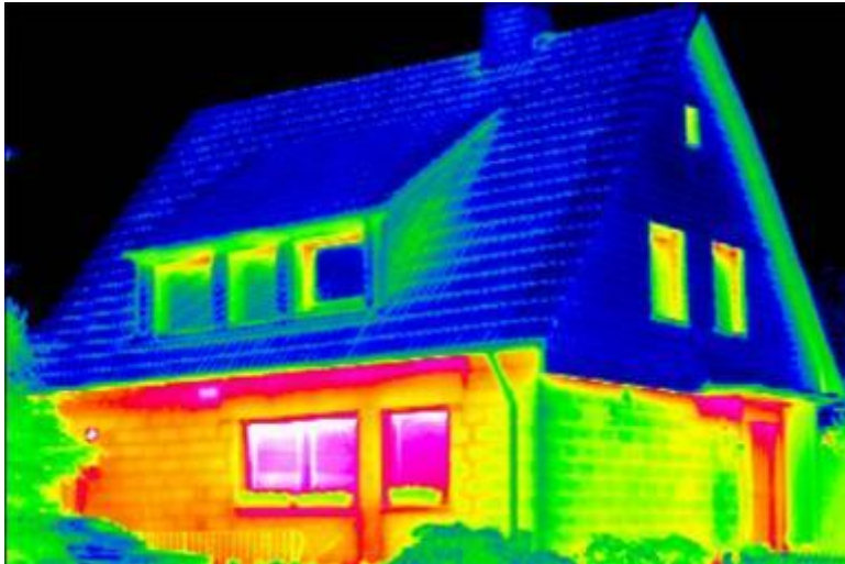
Eine Aufnahme mit Thermobildkamera und der „Blower Door Test“ macht auch unsichtbare Mängel bei der Wärmedämmung sichtbar.
