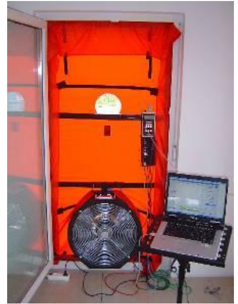
Eine Aufnahme mit Thermobildkamera und der „Blower Door Test“ macht auch unsichtbare Mängel bei der Wärmedämmung sichtbar.
