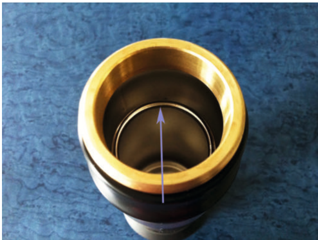
► Abb. 11 Maximale Einfüllhöhe des Stickstoff-Kanisters.
