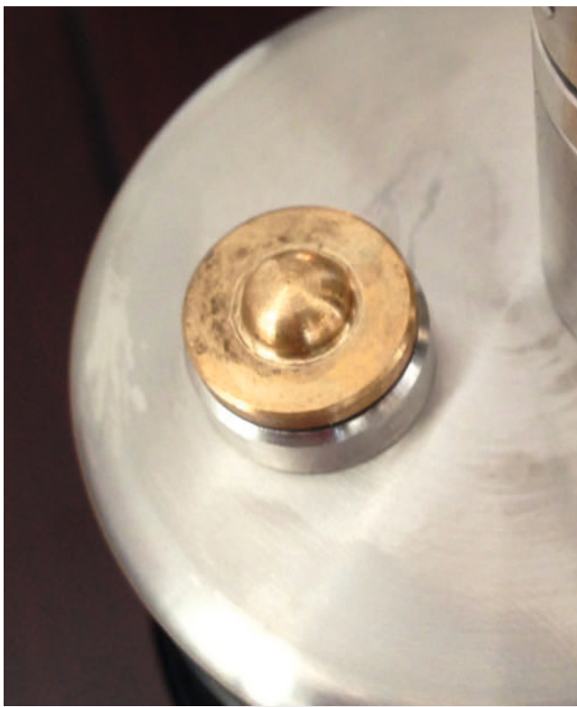
► Abb. 12 Auslassventil des Kryogen-Kanisters.
