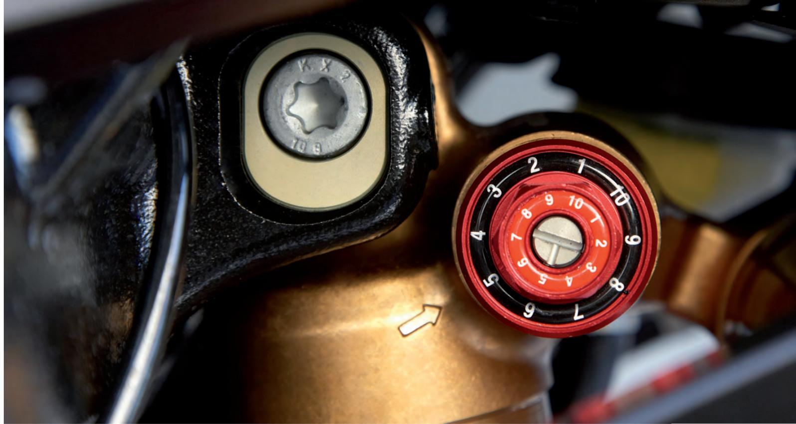
Eine Möglichkeit zur Anhebung des Fahrzeughecks und einer damit verbundenen Änderung der Fahrwerksgeometrie gestattet das exzentrisch gefertigte Einsatzstück am oberen Federbeinauge.
