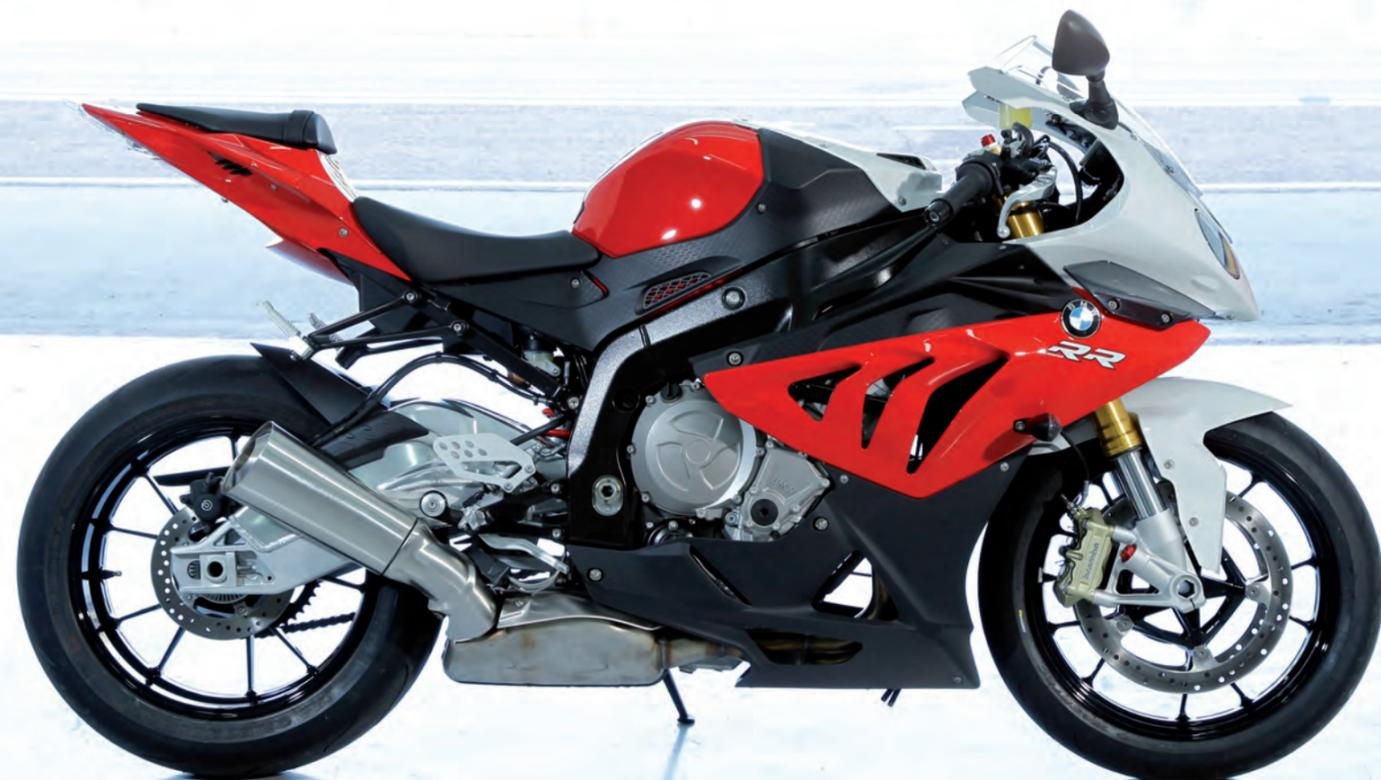
der neuen S 1000 RR. Im Zuge der dafür notwendigen Änderungen am Hauptrahmen wurde auch die Querschnittsfläche der Ansaugluftführung durch den Steuerkopf für noch effektiveren Luftdurchsatz vergrößert. Ein einstellbarer hydraulischer Lenkungsdämpfer rundet das Paket von Fahrwerksoptimierungen ab.
