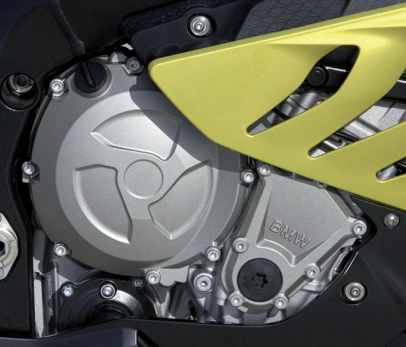
„Getrieben vom Ziel, einen sehr leichten Motor zu bauen, entschieden wir uns bei verschiedenen Gehäuseteilen für Magnesium als Werkstoff.“
