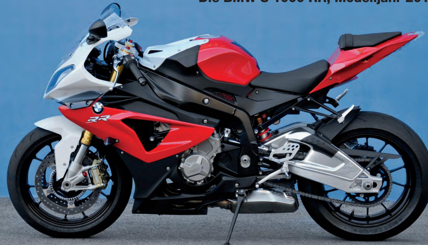
**Die neue Fahrlage und Fahrwerksgeometrie der RR resultieren aus modifizierten Werten für Steuerkopfwinkel, Offset, Lage des Schwingendrehpunkts sowie Gabelüberstand und Federbeinlänge.**
