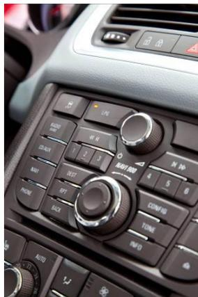
Ein neuer Schalter im Cockpit macht den Wechsel zwischen beiden Betriebsarten leichter denn je. Er befindet sich in gut erreichbarer Position im zentralen Bedienfeld. Ein integriertes Licht zeigt an, wenn sich das Fahrzeug im LPG-Modus befindet. Es erlischt, sobald auf den Benzin-Modus umgeschaltet wird.
