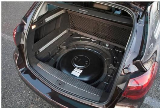
Opels maßgeschneidertes LPG-System beinhaltet auch eine intelligente Lösung für den 42 Liter großen Gasvorrat. Der Tank ist in der Reserveradmulde untergebracht und schränkt so weder den Platz im Passagierabteil noch die Kapazität des großzügigen Gepäckraums ein. Reifenreparatursets sind Standard in allen LPG-Fahrzeugen.
