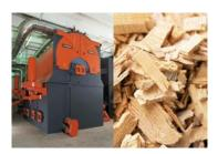
Im Jahre 1994 folgte die Inbetriebnahme einer Hackschnitzelheizung, die aus den in der Produktion entstehenden Holzabfällen so viel Wärmeenergie erzeugt, dass 20.000 qm Werkshallen, die Lacktrockenanlage und ein Wohnhaus mit 12 Wohneinheiten damit geheizt werden können. In den Sommermonaten reicht die so gewonnene Energie sogar dazu, örtliche Fernwärmegenossenschaften zu beliefern.
